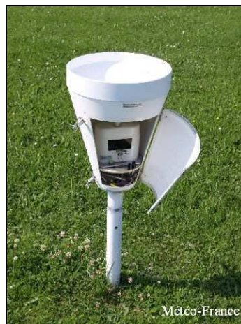
Photo 2 : pluviomètre enregistreur de type Précis Mécanique © Météo-France
