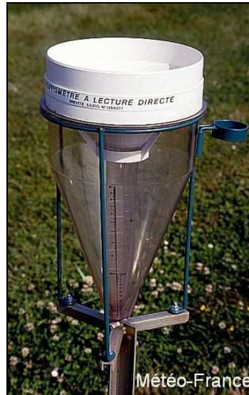
Photo 1 : Pluviomètre à lecture directe © Météo-France
